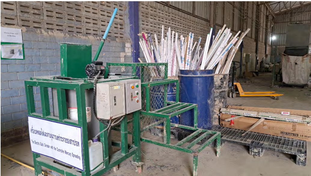
เครื่องบดหลอดไฟและควบคุมการแพร่กระจายของสารปรอท
