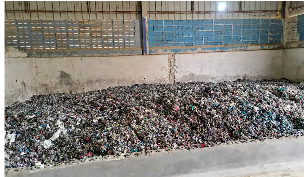
เศษวัสดุที่ตัดเป็นชิ้นเล็กๆนำมาผสมกับเศษน้ำมัน เตรียมส่งให้โรงปูน
